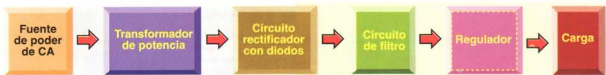
Figura 7.4. Estructura típica de una fuente de alimentación. El regulador es característico de las fuentes reguladas
